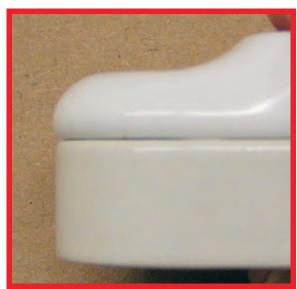
E'AMMESSA SOLTANTO UNA LEGGERA QUANTITA' DI VERNICE SUL LATO POSTERIORE DEI PEZZI ONLY A LIGHT SHADE OF PAINT ON BACK SIDE OF PIECES IS ADMITTED
