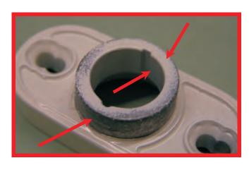
E'AMMESSA SOLTANTO UNA LEGGERA QUANTITA' DI VERNICE SUL LATO POSTERIORE DEI PEZZI ONLY A LIGHT SHADE OF PAINT ON BACK SIDE OF PIECES IS ADMITTED
