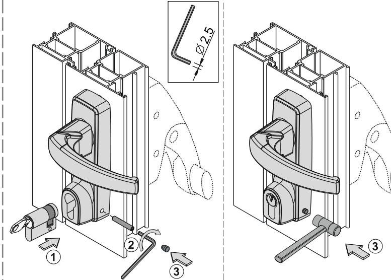
Sostituzione cilindro definitivo - Removal of final cylinder - Reemplacment du cylinder définitif - Reemplazo bombín definitivo - Demontieren des endgültigen Zylinders - Замена постоянного цилиндра - Demontaż wkładki docelowej
