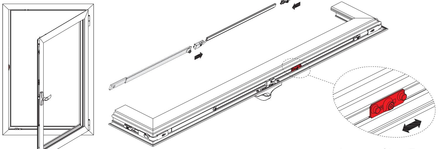
Fissare l'incontro (particolare **a**) sul telaio, allineare il cursore (particolare **b**) sull'anta come indicato in figura 1) e fissarlo.
