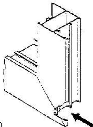
Prima di assemblare l'infisso eseguire la spuntatura delle coste dell'anta mobile.
