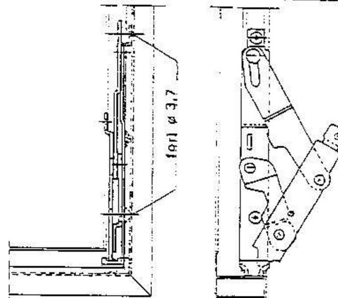
Eeguire le forature ed avvitare la KLEMDUE sul telaio fisso.
