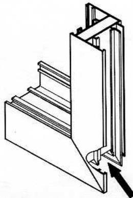
Prima di assemblare l'infisso, eseguire la spuntatura delle coste dell'anta mobile
