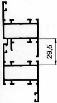
NB: Solo per nuovo NC 40 e 50 complanare, aumentare la luce perimetrale fra telaio e battente a mm. 29,5
