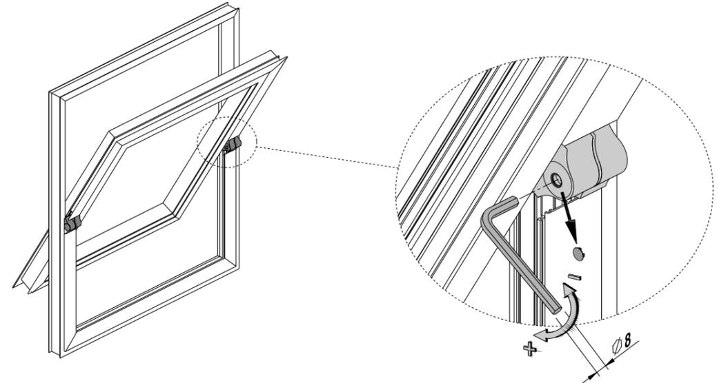
REGOLAZIONE IN ALTEZZA (-1,5/+1,5 mm) - VERTICAL ADJUSTMENT (-1,5/+1,5 mm) - REGLAGE VERTICAL (-1,5/+1,5 mm) - REGULACIÓN VERTICAL (-1,5/+1,5 mm) -
