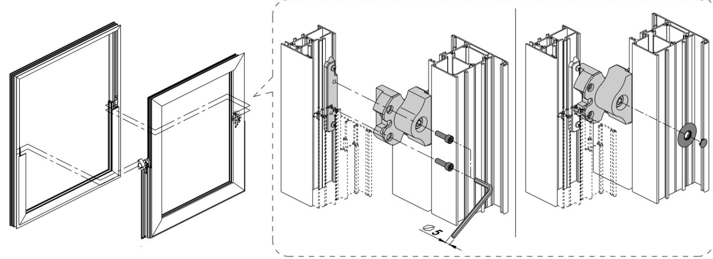
REGOLAZIONE FRIZIONAMENTO - FRICTIONING ADJUSTMENT - REGLAGE DU FROTTEMENT - REGULACIÓN DEL ROZAMIENTO - REIBUNGSEINSTELLUNG -
