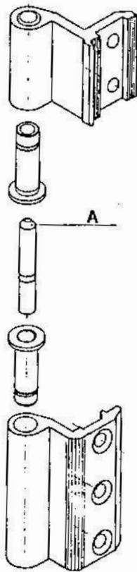
Non abbinare perni e boccole di questo tipo con altre fornite nelle precedenti dotazioni.
