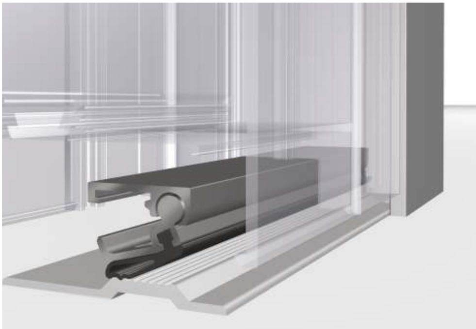
Il movimento a cerniera mette in pressione la guarnizione automaticamente solo a porta completamente chiusa. Aprendo la porta, la guarnizione si solleva evitando il trascinamento sul pavimento ed eliminando l'attrito e l'usura.
